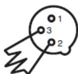
La terminación reduce los errores de señal y evita los problemas de transmisión de señal e interferencias. Es siempre aconsejable conectar un terminador DMX (resistencia 120 ohmios, 1/4 W) entre PIN 2 (DMX-) y PIN 3 (DMX +) del último dispositivo. **Figura 4**
